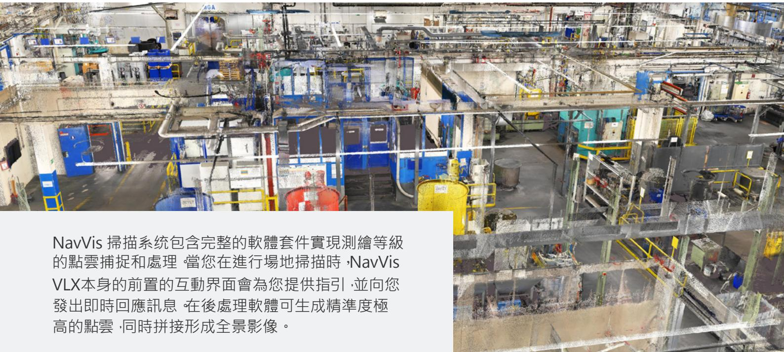
NavVis 掃描系統包含完整的軟體套件實現測繪等級的點雲捕捉和處理。當您在進行場地掃描時，NavVis VLX本身的前置的互動界面會為您提供指引，並向您發出即時回應訊息。在後處理軟體可生成精準度極高的點雲，同時拼接形成全景影像。
